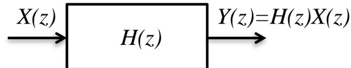
$H(z)$  es la función de transferencia. Para  $z=e^{j\Omega}$ ,  $H(e^{j\Omega})$  es la respuesta en frecuencia del sistema.
