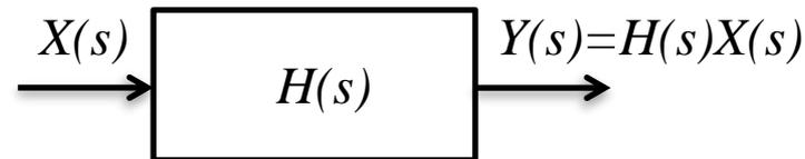
$H(s)$  es la función de transferencia. Para  $s = j\omega$ ,  $H(j\omega)$  es la respuesta en frecuencia del sistema.
