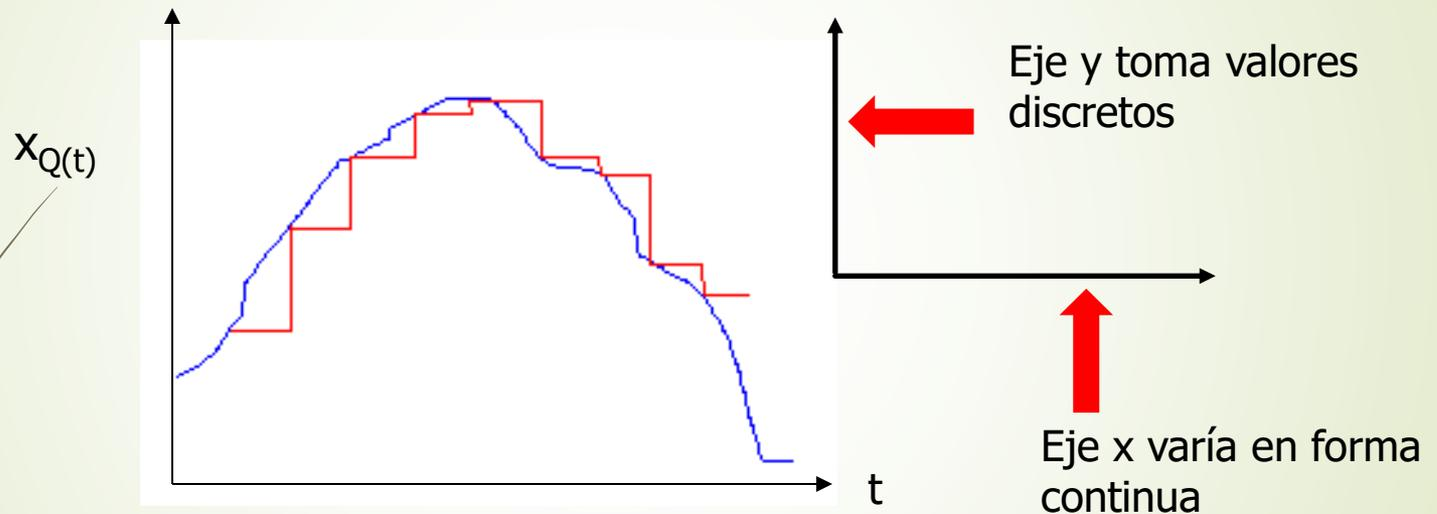
Tiempo continuo, amplitud discreta. La amplitud solo toma determinados valores.
