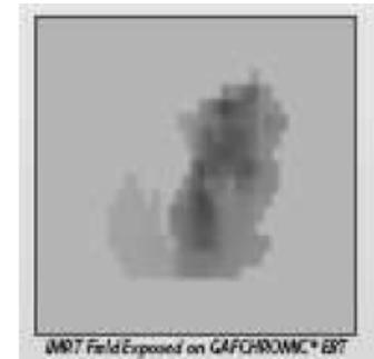
Placa radiocrómica. Compuesta de una película de polímero se oscurece proporcionalmente a la dosis (sin revelado).
