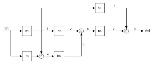
Dónde:  $h_1[n]=3\delta[n]$ ;  $h_2[n]=\delta[n]$ ;  $h_3[n]=u[n]$ ;  $h_4[n]=2^n u[n]$ ;  $h_5[n]=0$ ;  $h_6[n]=\delta[n]$
