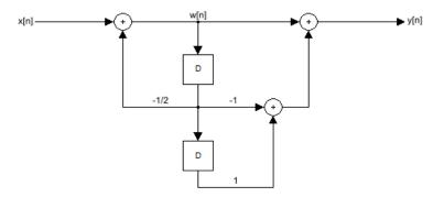
Sugerencia: Descomponer dicho sistema en dos subsistemas. Entonces podemos aplicar la operación de convolución a dichos subsistemas. Para el primer subsistema tenemos:
