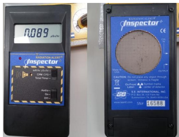
Figura 1. Fotos del detector marca Inspector: parte frontal (izquierda) y de la parte trasera (derecha). En la foto de la parte trasera se observa la ventana de detección.
