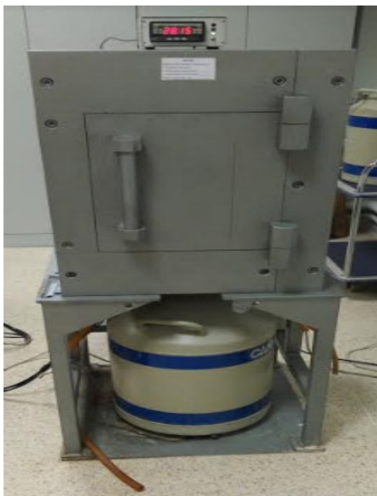
Figura 28: Blindaje y refrigeración del detector de germanio
