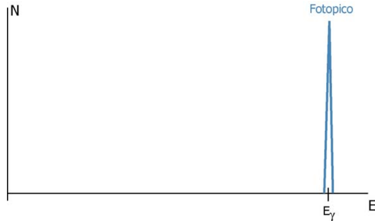
Figura 1.5: Espectro ideal obtenido con un detector grande.
