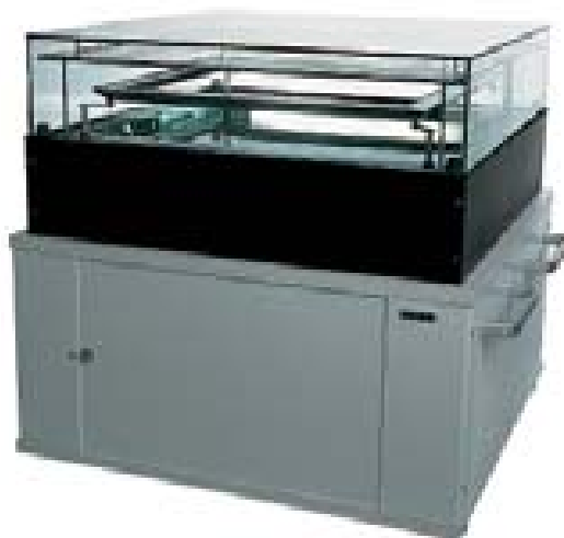
Figura 2.1- La cámara de niebla de difusión del IFIC.
