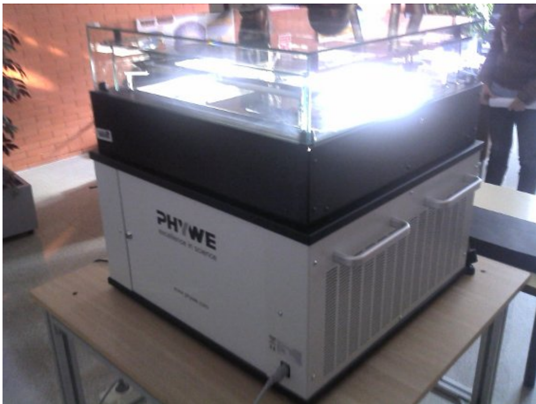
Figura 4: Cámara de difusión empleada en nuestro experimento
