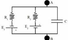
Considerar que el circuito se encuentra funcionando hace suficiente tiempo para que el capacitor esté totalmente cargado (estado estacionario) y que  $E_1$  = 80 mV;  $E_2$  = 50 mV;  $R_1$  = 1 M $\Omega$ ;  $R_2$  = 10 M $\Omega$ ; C = 50 pF.
