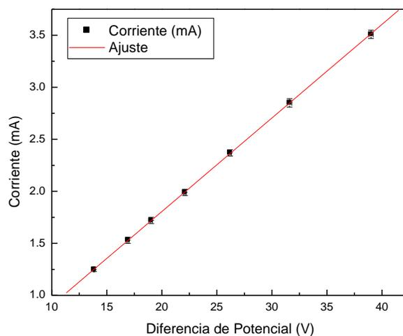
**Figura 1.** Corriente que circula por una resistencia ( $R = 10 \text{ k}\Omega$ ) en función de la diferencia de tensión aplicada sobre la misma. Los símbolos (cuadrados) representan los valores de corriente medidos, la línea continua es un ajuste lineal a los datos. (Aclarar cuando se usa otra representación, semi-logarítmica o doble-logarítmica, por ej.)
