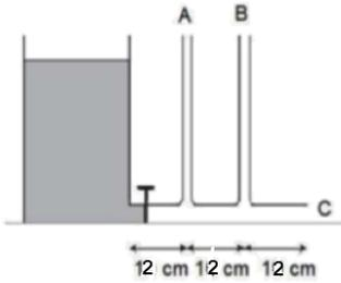
En el punto a) podemos aplicar Bernoulli pues se trata de un fluido no viscoso así despreciando la velocidad de descenso en el depósito, teniendo en cuenta que cuando el fluido es no viscoso siendo la sección del tubo horizontal constante  $v_A = v_B$ ,  $p_A = p_B$
