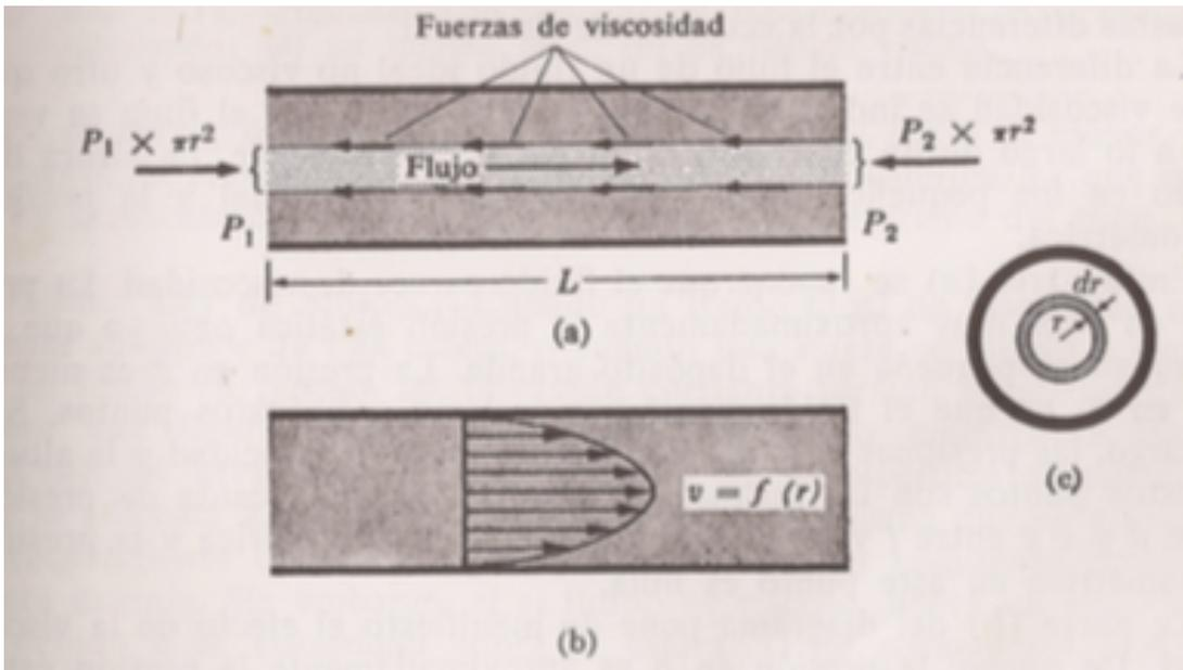
y si consideramos un tubo imaginario de radio  $r$  y longitud  $L$  con eje en el centro del tubo que se mueve a velocidad constante  $v(r)$  tendremos que las fuerzas de presión deben equilibrar a las viscosas
