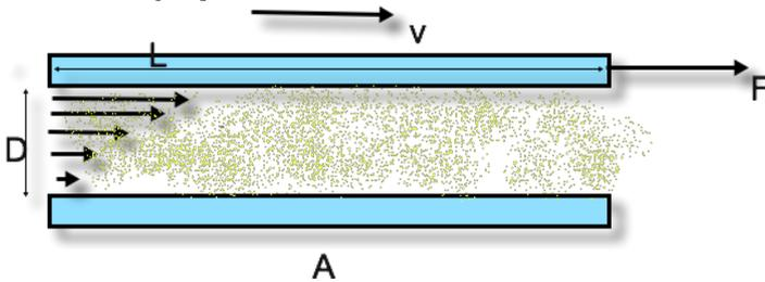
y comprobáramos que es proporcional al área, a la velocidad e inversamente proporcional a la separación, siendo el coeficiente de proporcionalidad el llamado coeficiente de viscosidad  $\eta$
