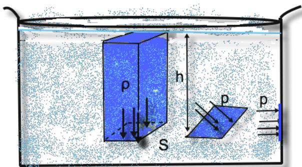
La presión en un punto en  $h$  debajo de la superficie libre del líquido será el peso de una columna líquida de densidad  $\rho$ , de altura  $h$  y base  $S$  dividido la superficie  $S$
