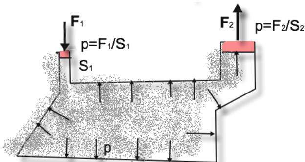
Este principio tiene muchas aplicaciones ya que como por ejemplo en la figura se cumple que  $p_1 = p_2 \Rightarrow \frac{F_1}{S_1} = \frac{F_2}{S_2}$  podemos despejar  $F_2 = \frac{S_2}{S_1} F_1$  donde vemos que la fuerza queda multiplicada por un factor que depende del cociente de las superficies. Esto se utiliza en los crickets hidráulicos (para levantar autos), frenos de un auto y prensas hidráulicas.
