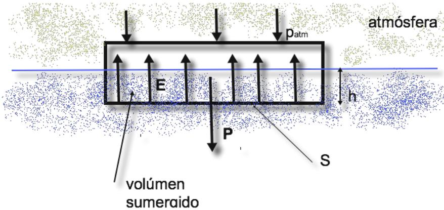
El empuje vertical que recibe el cuerpo se debe a la diferencia de presión entre la parte superior y los puntos sumergidos en la base, ya que las fuerzas laterales se equilibran, y así tendremos suponiendo que la base del cuerpo tiene área  $S$  y está sumergido una cantidad  $h$
