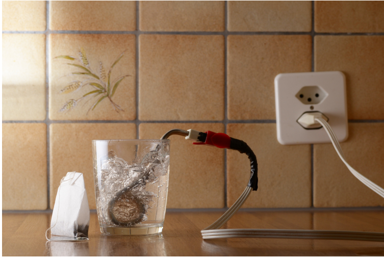
Figura 8: Calentador eléctrico de inmersión llevando a ebullición agua en un vaso, y un saquito de té, mirándolo todo.
