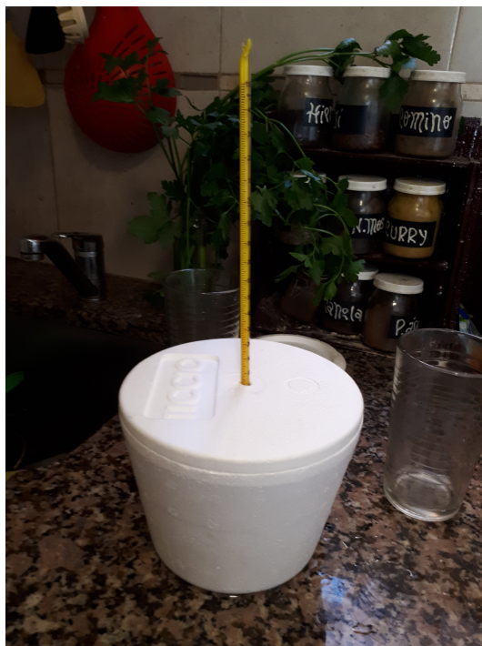
Figura 9: Termómetro fijado a la tapa del recipiente aislante.
