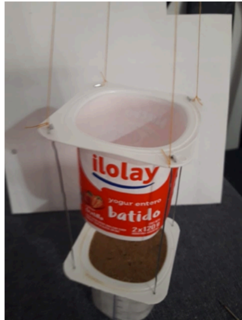
Figura 15: montaje de los dos vasos mediante clips e hilo.
