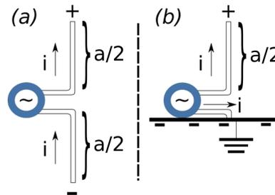
**Problema 5. Antenas finitas** Considere ahora el caso de la antena dipolar lineal, donde ahora  $c \approx a f_0$ . Asumiendo que la corriente a lo largo de cada alambre es de la forma  $I(x, t) \approx I_0 \cos(2\pi f_0 t) \frac{\sin(\pi f_0 (a-2z)/c)}{\sin(\pi f_0 a/c)}$  determine a) La distribución de densidad de carga sobre la antena. b) Los campos eléctrico y magnético a grandes distancias c) La potencia total radiada y su distribución espacial.
