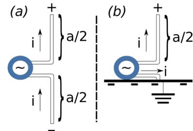
**Problema 4. Antenas finitas** Considere ahora el caso de la antena dipolar lineal, donde ahora  $c \approx af_0$ . Asumiendo que la corriente a lo largo de cada alambre es de la forma  $I(x, t) \approx I_0 \cos(2\pi f_0 t) \frac{\sin(\pi f_0(a-2z)/c)}{\sin(\pi f_0 a/c)}$  determine a) La distribución de densidad de carga sobre la antena. b) Los campos eléctrico y magnético a grandes distancias c) La potencia total radiada y su distribución espacial.
