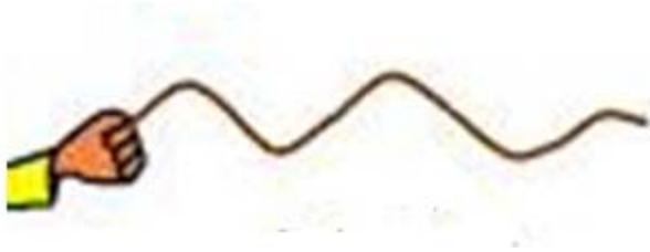
Si la cuerda pone a oscilar en dirección vertical (las partículas vibran en la dirección vertical) se dice que la cuerda tiene polarización lineal y el vector polarización apunta en la dirección de vibración.
