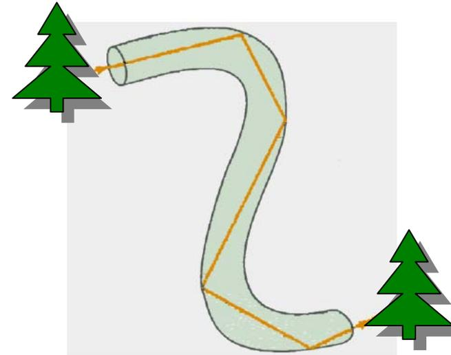
Principio de funcionamiento de las fibras ópticas
