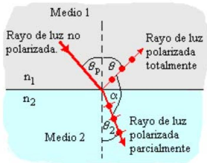
En los casos en que el rayo reflejado y el refractado tengan direcciones perpendiculares entre sí, la luz reflejada se polariza en su totalidad en la dirección perpendicular al plano de incidencia. Teniendo en cuenta la ley de Snell se obtiene que:
