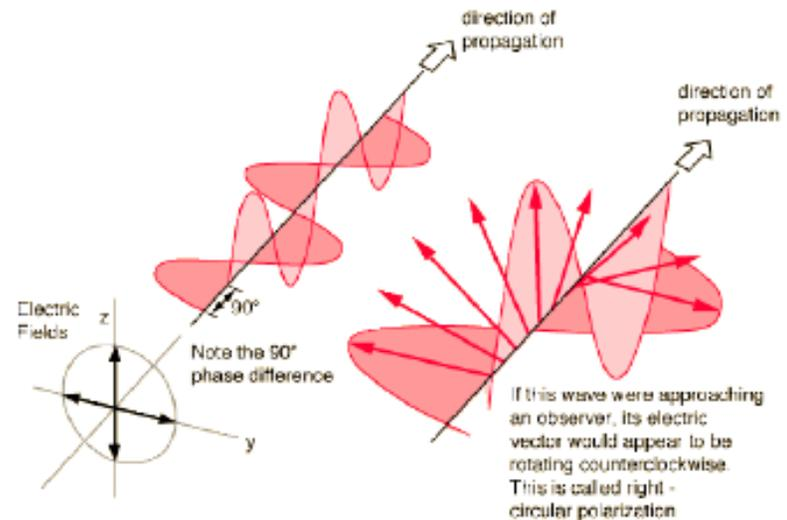
La **luz natural no está polarizada**, es una mezcla de ondas linealmente polarizadas en todas las direcciones transversales posibles.
