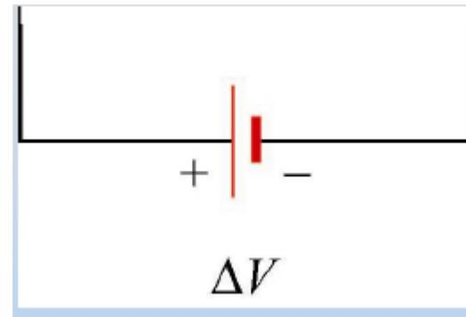
Fuente de tensión mantiene una diferencia de potencial constante entre los terminales. Provee la energía electromotriz
