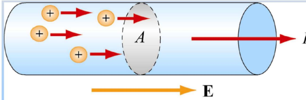
Cuando la corriente está fluyendo, el campo eléctrico dentro NO es cero, el conductor NO es una superficie equipotencial
