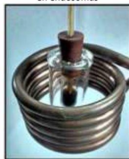
Medición del efecto hipertérmico bajo campo RF en un coloide
