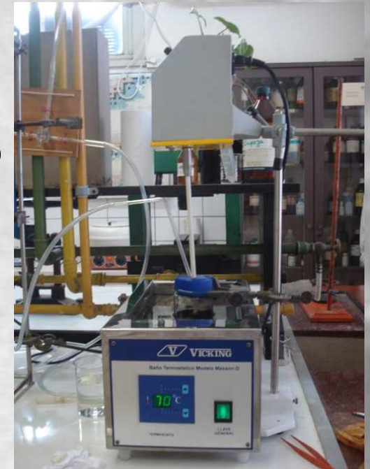
ESQUEMA DEL REACTOR UTILIZADO PARA LA SÍNTESIS DE MAGHEMITA
