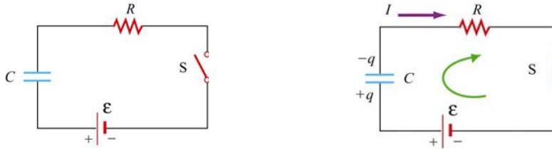
Si tenemos un circuito como el de la figura, en el cual el capacitor está inicialmente descargado ( $q=0$  en  $t=0$ ) y en el instante  $t=0$  se cierra la llave S, comienza a circular una corriente I y el capacitor comienza a cargarse. Aplicando la ley de Kirchhoff en un lazo cerrado, podemos escribir:
